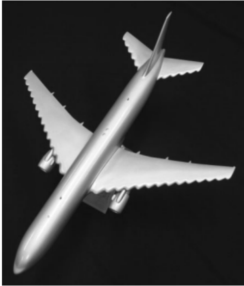
Slika 12: Model komercijalnog mlaznog zrakoplova s tuberkulima na vanjskim dijelovima krila i stabilizatora (Preuzeto od Fish, F. E., Weber, P. W., Murray, M. M., Laurens, E. H., (2011.): The Tubercles on Humpback Whales' Flippers: Application of Bio-Inspired Technology. Integrative and Comparative Biology, 51 (1): 203–213)
