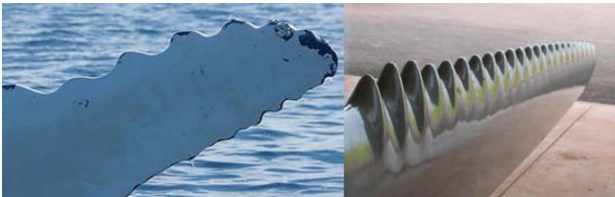
Slika 11: Pektoralna peraja grbavog kita sa tuberkulima i prototip lopatice za vjetroelektrane
